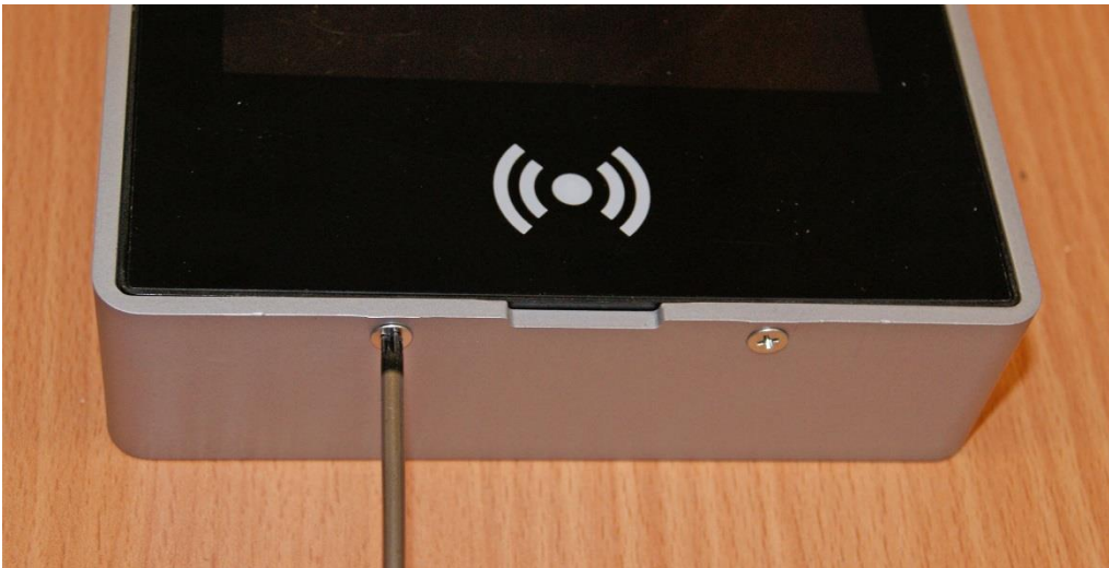
Abbildung 9: Entfernen der Schraube unten im Einbaurahmen
